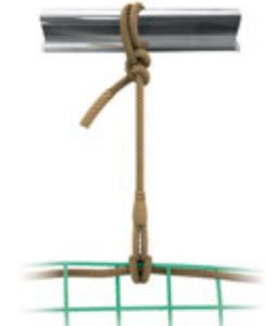
Netzaufhängung durch Umschlingen und Verknoten des Aufhängegeseiles am Tragelement.
