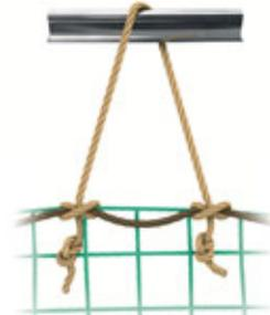
Seile sind gegen Aufdrehen zu sichern und dürfen durch scharfe Kanten nicht beschädigt werden können. ④
