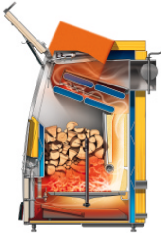
Abbildung 11: moderne Holzfeuerung mit Hochtemperaturverbrennung
