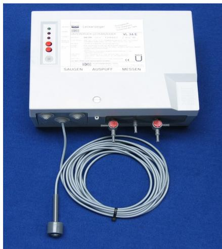
überwacht nicht nur einwandige Behälter mit Leckschutzauskleidung, sondern mit dem zugehörigen Schwimmerschalter zusätzlich auch Auffangräume, Dom- und Kontrollschächte sowie Pumpensämpfe etc.
