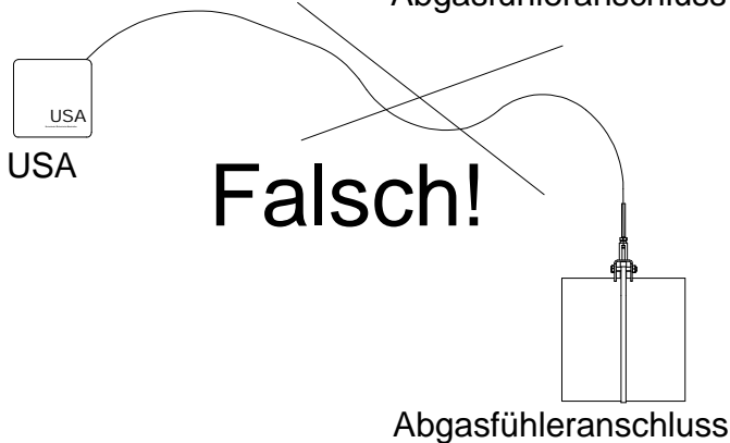
Bild: Verlegen der Druckmessleitung
