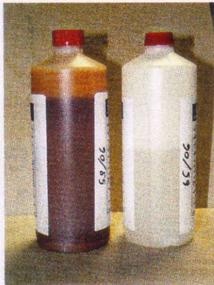
Links: nicht ÖNORM-gerechtes Heizungswasser. Rechts: klar wie Quellwasser, so soll es sein
