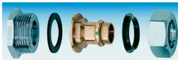
■ Aufbau einer Isolierschraubung, die bei Mischinstallationen mit unterschiedlichen Werkstoffen zur Vermeidung von Bimetallkorrosion eingesetzt werden kann.
