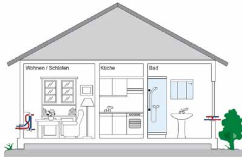
Systemskizze eines Einzelraumgerätes mit Wärmerückgewinnung
