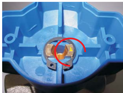
T-Markierung an der Welle. Zeigt die Kugelstellung im Inneren, wenn der Griff demontiert ist.
