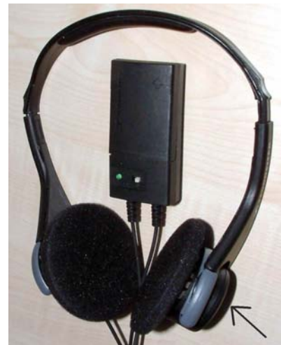
Bild 4. Offener Kopfhörer mit Antischall nach dem Steuerungsprinzip (Sennheiser HDC 451). Der Pfeil zeigt zum Mikrofon, das sich nahe der Oberfläche der Hörerkapsel befindet. An der anderen Kapsel ist analog ein zweites Mikrofon vorhanden. Das rechteckige Gehäuse enthält bei diesem Hörer nur die Batterien.
