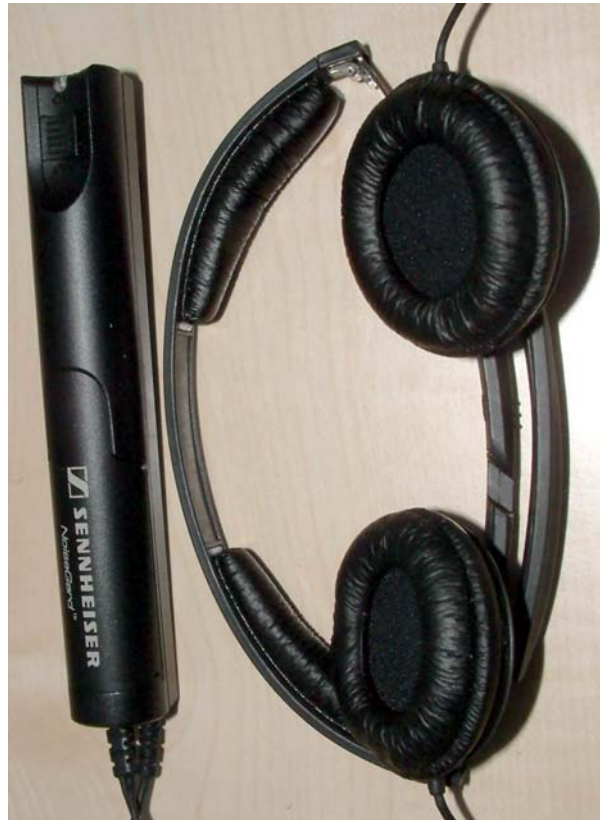
Bild 5. Antischallkopfhörer nach dem Regelungsprinzip und dazugehöriges Gehäuse für Elektronik und Batterien. Der Hörer ist zusammengeklappt dargestellt.
