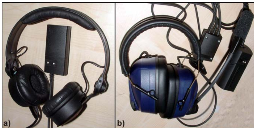
Bild 7. Zwei aktive, geschlossene Kopfhörertypen mit zusätzlichem passiven Lärmschutz (Details im Text).
