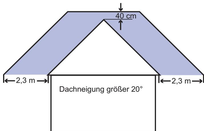
Abb. 2 Unzulässige Bereiche für Schornsteinmündungen (Dachneigung > 20°), Quelle: ZIV
