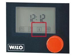
> automatische Erkennung der Rücklauftemperatur, durch integrierten Temperaturfühler
