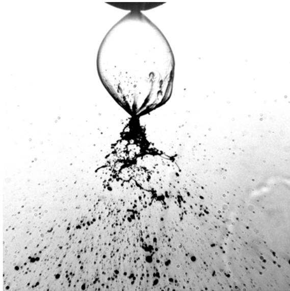
**Abbildung 15:** Sprühbild einer Druckdralldüse ca. 1 – 2 ms nach Brennerschluss
