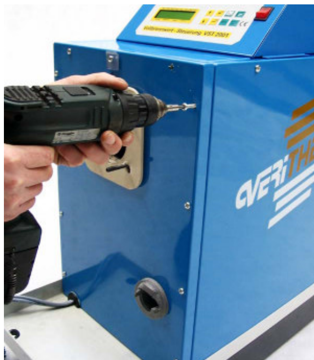
Bild 3-9: Abnehmen der Vorderwandabdeckung.
