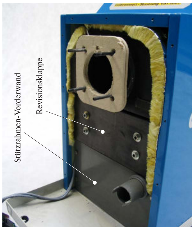
Bild 3-10: Kessel ohne Vorderwandabdeckung, mit Revisionsklappe (Primärwärmetauscher) und Stützrahmen-Vorderwand (KU-Wärmetauscher).
