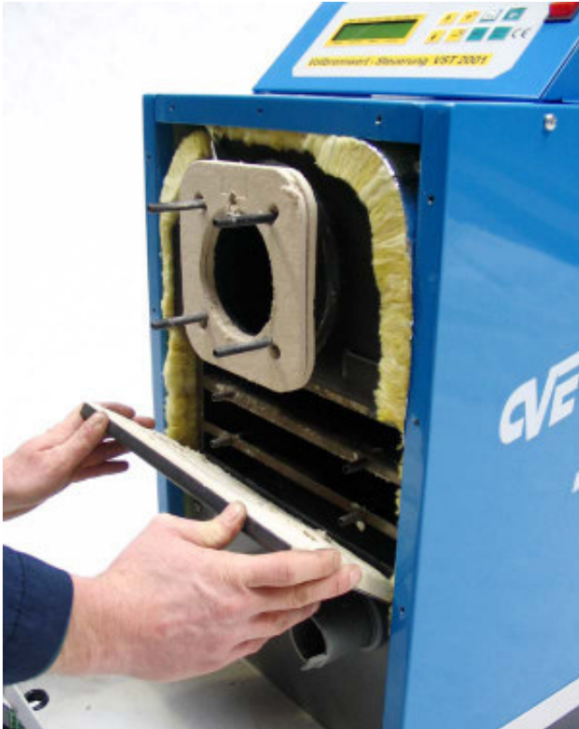
Bild 3-11: Revisionsklappe abnehmen zur Inspektion/Reinigung des Primärwärmetauschers.
