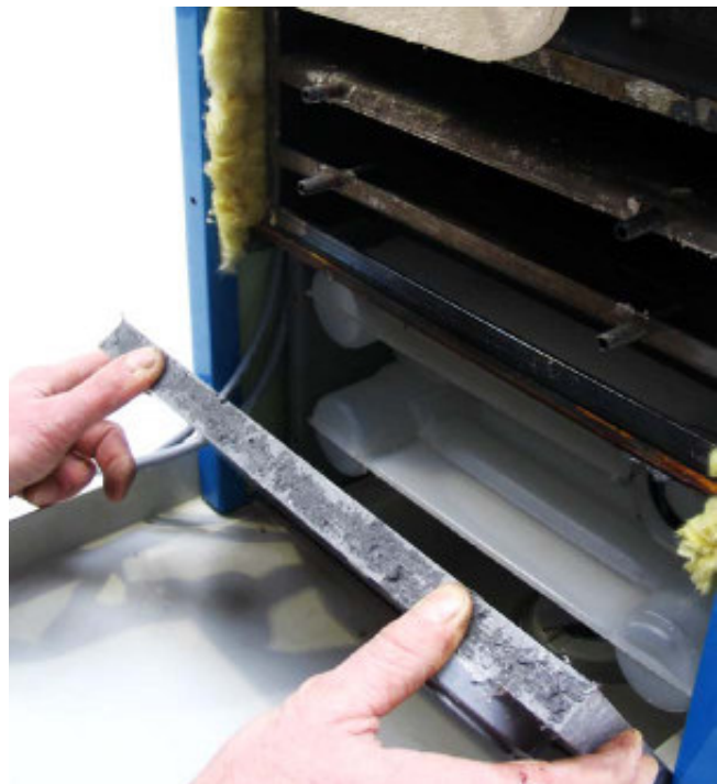
Bild 3-14: Demontage der Stützrahmen-Vorderwand zur Inspektion/Reinigung des Kunststoff-Wärmetauschers.
