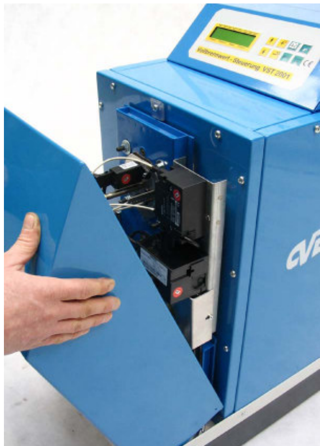
Bild 3-2: Abnehmen der Schallschutzhaube.
