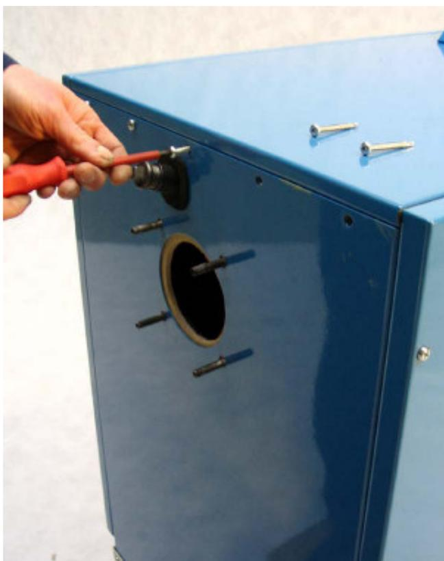
**Bild 3-10:** Revisionsklappe abnehmen zur Inspektion des Primär-Wärmetauschers.
