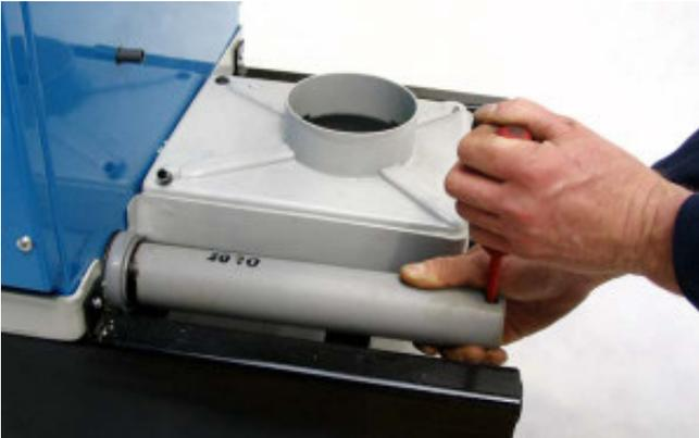
**Bild 3-15:** Demontage des hinteren Zuluftrohrs.
