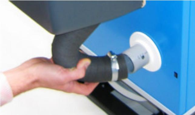
**Bild 3-5:** Zuluftschlauch abziehen. Die Öffnung zur Messung der Verbrennungslufttemperatur ist während des Betriebes durch den Schlauch verdeckt.
