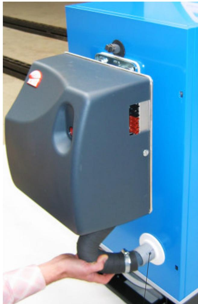
Messung der Verbrennungslufttemperatur
