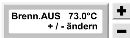
Mit den "+ / -"-Tasten lässt sich der Brenner-Abschaltpunkt im Bereich von 65°C bis 85°C einstellen.
