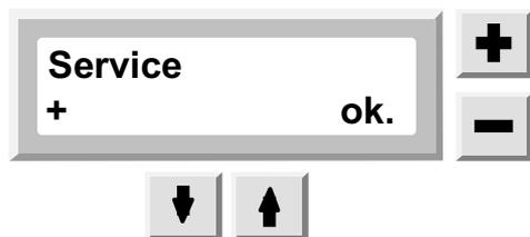
Mit der Taste "+" kann ein Inbetriebnahme - oder Serviceprotokoll ( DIN A4 ) ausgedruckt werden. Die Daten werden seriell über RS 232 ausgegeben. ( Drucker SDR 232 auf Anfrage erhältlich). Gleichfalls kann mit dem PC-Programm PSAFE 2.0 ein Protokoll im PC ( Laptop) ausgegeben werden, sodaß die Statistik und momentanen Messwerte direkt übertragen und ausgewertet und imTEXT Mode ergänzt werden können.
