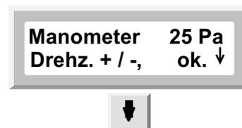
Jetzt stellt man die Gebläsedrehzahl mit Hilfe der plus / minus-Tasten ( plus = mehr Drehzahl ) so ein, bis der Unterdruck am Schrägrohr- Manometer 25 Pa anzeigt, dann den Unterdruckschlauch der Steuerung wieder aufstecken, sodaß die Elektronik den Druck messen kann. Dann ca.10 sek.warten und mit der Pfeil runter-Taste bestätigen.
