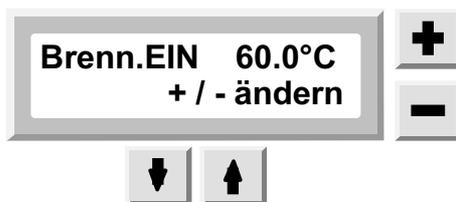
Mit den "+ / -"-Tasten lässt sich der Brenner START im Bereich von 50°C bis 65°C einstellen.
