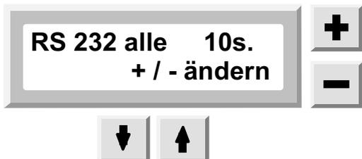
Ene 9pol.Verbindung zu einem PC erlaubt die Übertragung aller Soll- und Messwerte sowie digitale Zustände von Pumpen,Mischer ,Brenner ,Gebläse usw. an einen PC, es muß hierbei das Programm VISUAL-Control 2001 auf dem PC mittels CD installiert werden . Einzelheiten sind der Betriebsanleitung der VISUAL 2001 zu entnehmen.
