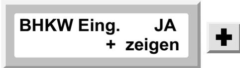
Kontrolle des Einganges bei BHKW-Betrieb
