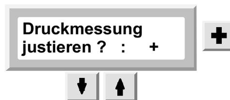
Durch Drücken der "+"-Taste wird die Justage der Druckmessung eingeleitet. Hierfür wird ein Unterdruck-Manometer benötigt.
