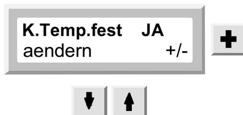
Soll die Kesseltemperatur einen fixierten Brenner EIN Schaltpunkt und einen festen Brenner AUS- Schaltpunkt haben, so ist hierbei JA einzugeben, bei VERITHERM ist nur JA möglich, da ein ST 37 Wärmetauscher verwendet wird.
