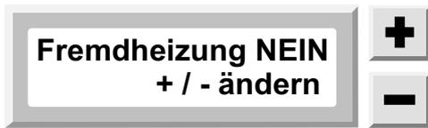
Mit den "+ / -"-Tasten lässt sich die Anbindung weiterer Wärmequellen realisieren, sodass bei "JA" der Start des Brenners verhindert wird, wenn eine externe Heizquelle eine höhere Temp.liefert als die momentane Kesseltemperatur., hierbei öffnet dann der Mischer oder bei Brauchwasser aktiviert sich die Lade-Pumpe.
