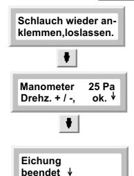
Unterdruckschlauch (Siliconschlauch) der Elektronik vom Kesselstutzen entfernen und das Unterdruckmessgerät dort anstecken, sodaß im Brennraum eine Messung am Schrägrohr-Manometer erfolgen kann.
