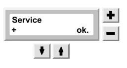
Mit der Taste "+ " kann ein Inbetriebnahme - oder Serviceprotokoll (DIN A4) ausgedruckt werden. Die Daten werden seriell über RS 232 ausgegeben. (Drucker SDR 232 auf Anfrage erhältlich). Gleichfalls kann mit dem PC-Programm PSAFE 2.0 ein Protokoll im PC (Laptop) ausgegeben werden, sodaß die Statistik und momentanen Messwerte direkt übertragen und ausgewertet und imTEXT Mode ergänzt werden können.
