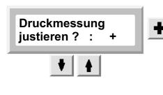
Durch Drücken der "+"-Taste wird die Justage der Druckmessung eingeleitet. Hierfür wird ein Unterdruck-Manometer benötigt.
