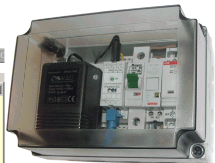
festverdrahtete Pumpensteuerung mit IPswitch-SG anstelle IPswitch-SPS
