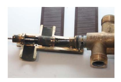
Symptom- und Schadensentwicklung, "... > Wasserschaden < durch deformierte O-Ringe"
